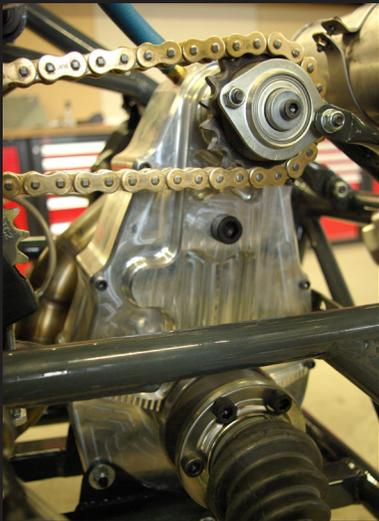
Boitier de transmission avec marche arrière mécanique
